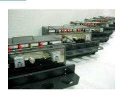
Предназначен для нанесения декоративных металлических покрытий на токопроводящие поверхности способом электрохимической металлизации (метод трибогальваники, метод электролитического натирания).
