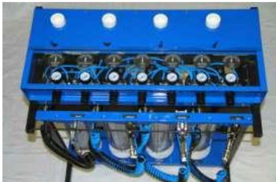
Предназначена для формирования покрытия, схожего по потребительским свойствам с покрытием хромом, на поверхностях различных материалов путём переноса рабочих реагентов посредством пневматических распылительных пистолетов. Установка химической металлизации серии «Chrome MX»: MX-2 имеет ряд отличительных особенностей:
