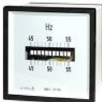
Частотометр с одним горизонтальным рядом используется для измерения частоты от 45 Гц до 65 Гц..
